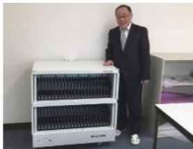
公立小中学校に設置される充電保管庫。生徒44人分の端末を充電します。
